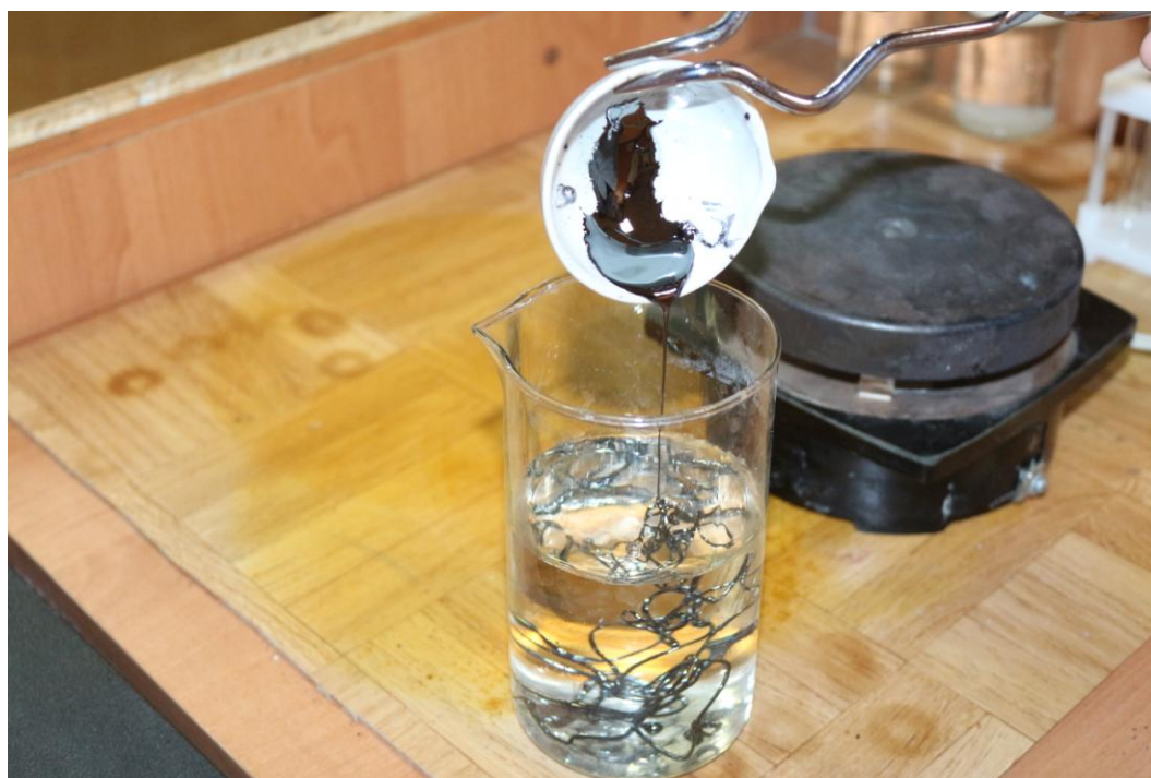
Рис.3. Быстрое охлаждение расплава селена в дистиллированной воде (Павлютенко А.И., Истомин Н.С.)
