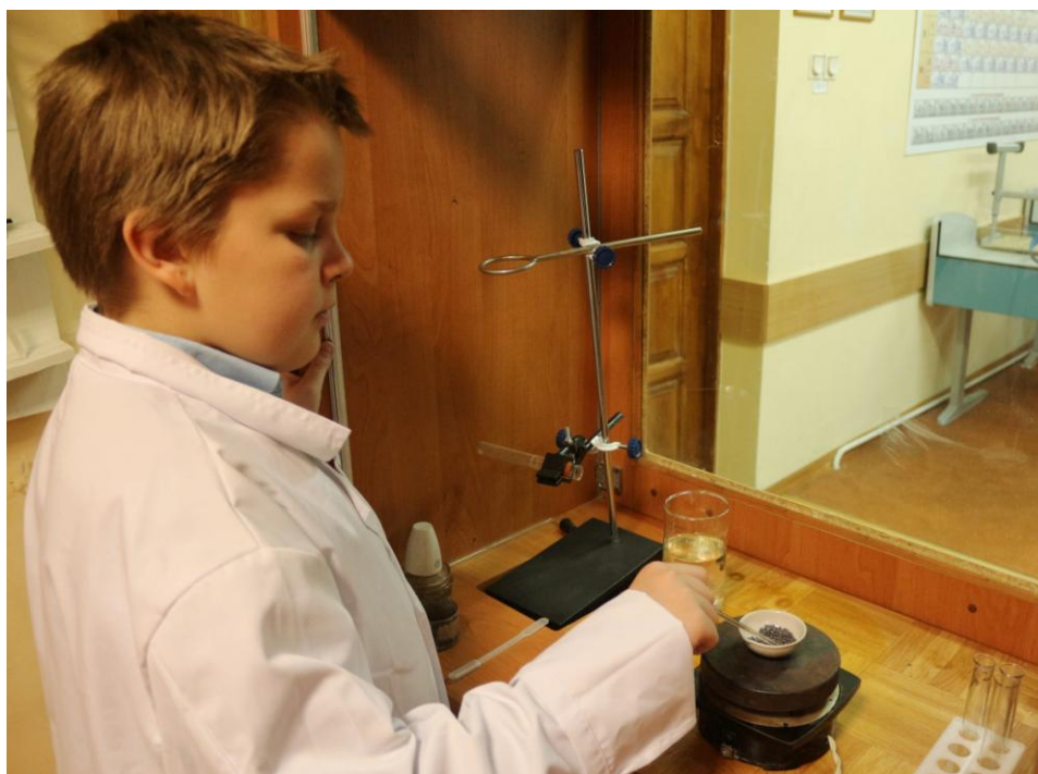
Рис.2. Начало операции нагревания исходного образца селена в фарфоровой чашке на электрической плитке (Павлютенко А.И., Истомин Н.С.)
